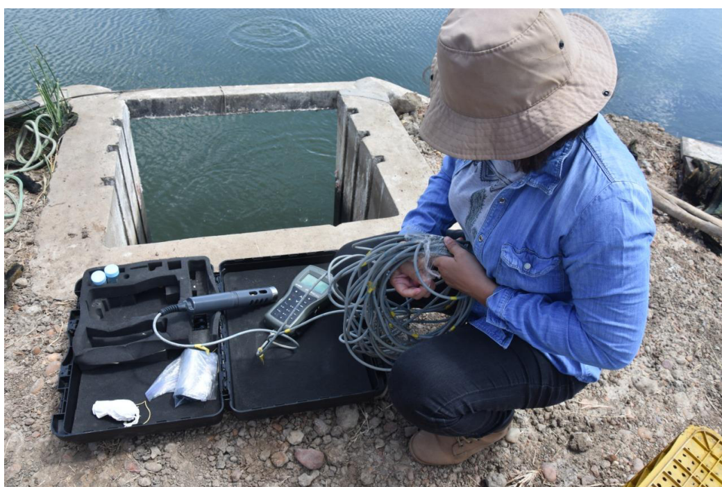
Figura 3- Utilização da sonda multiparamétrica modelo Hanna HI 9828 para medição in loco de parâmetros físico-químicos do efluente
