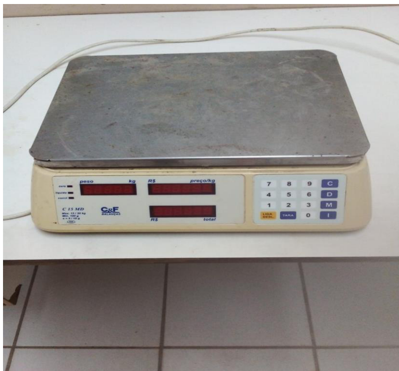
Figura 6- Balança eletrônica com resolução 2g.
