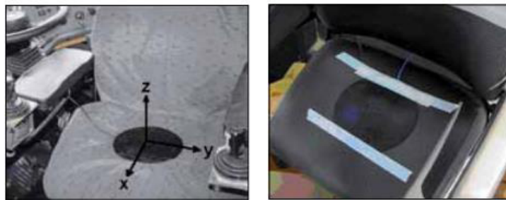
Figura 8- Posicionamento de sensor para aferição de VCI em trabalhadores sentados
