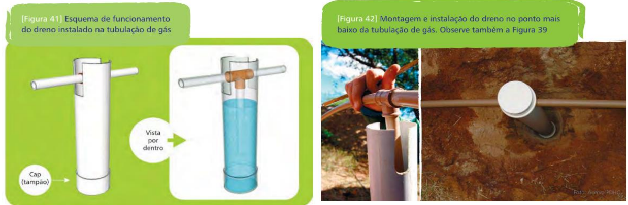
Figura 4 – Dreno de remoção de umidade
