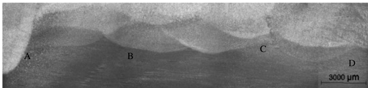
Figura 10. Extensão da ZAC GG com a relação de energia 5/5 kJ/cm com TTPS.
