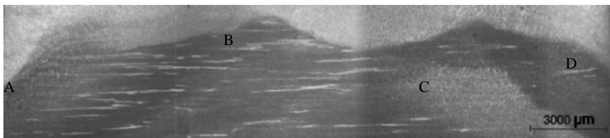
Figura 11. Extensão da ZAC GG com a relação de energia 15/5 kJ/cm sem TTPS.
