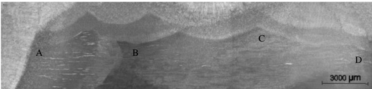
Figura 8. Extensão da ZAC GG com a relação de energia 5/5 kJ/cm sem TTPS.
