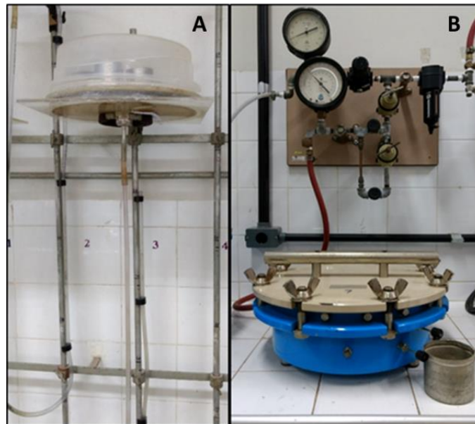
Figura 6 - Mesa de tensão (A) e extrator de Richards (B) usados para a confecção das curvas característica de retenção de água no solo (CCRAS)
