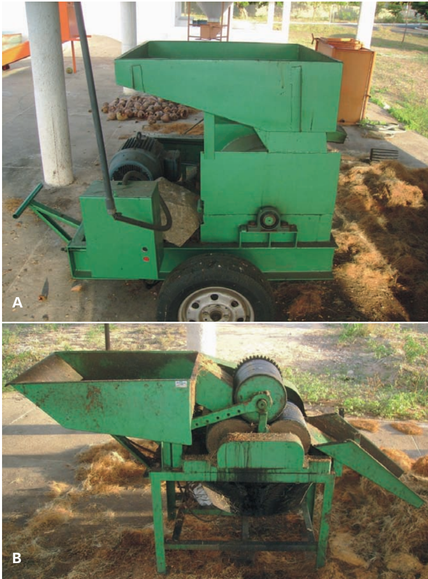
Figura 2. Máquina de trituração (A) e prensagem (B) da casca do coco-verde, onde era produzido o LCCV.
