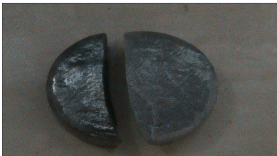
Figura 4. Amostra fraturada após ensaio de compressão diametral
