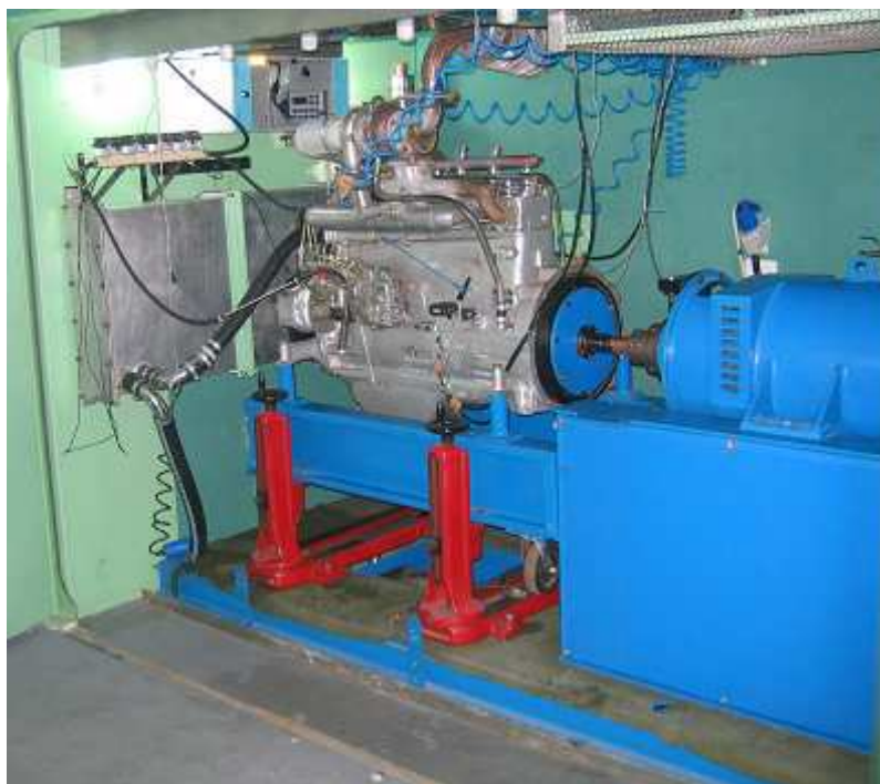
Figura 1: Bancada dinâmométrica em operação com o motor MWM 229.
