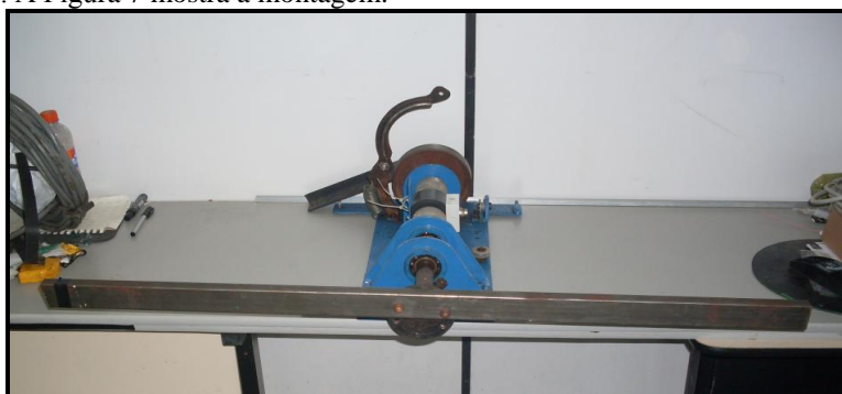
Figura 7 – Montagem para calibração do torquímetro no conjunto dinamômetro
