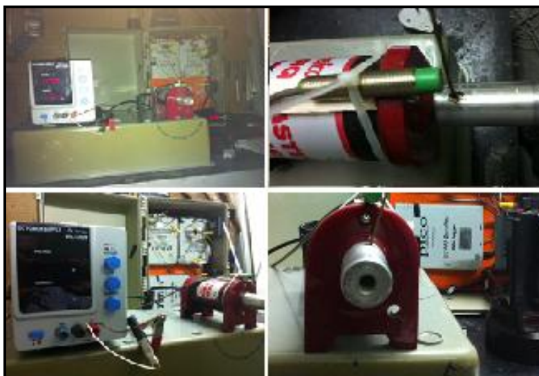
Figura 8 – Imagens do ensaio estroboscópico (calibração do tacômetro)
