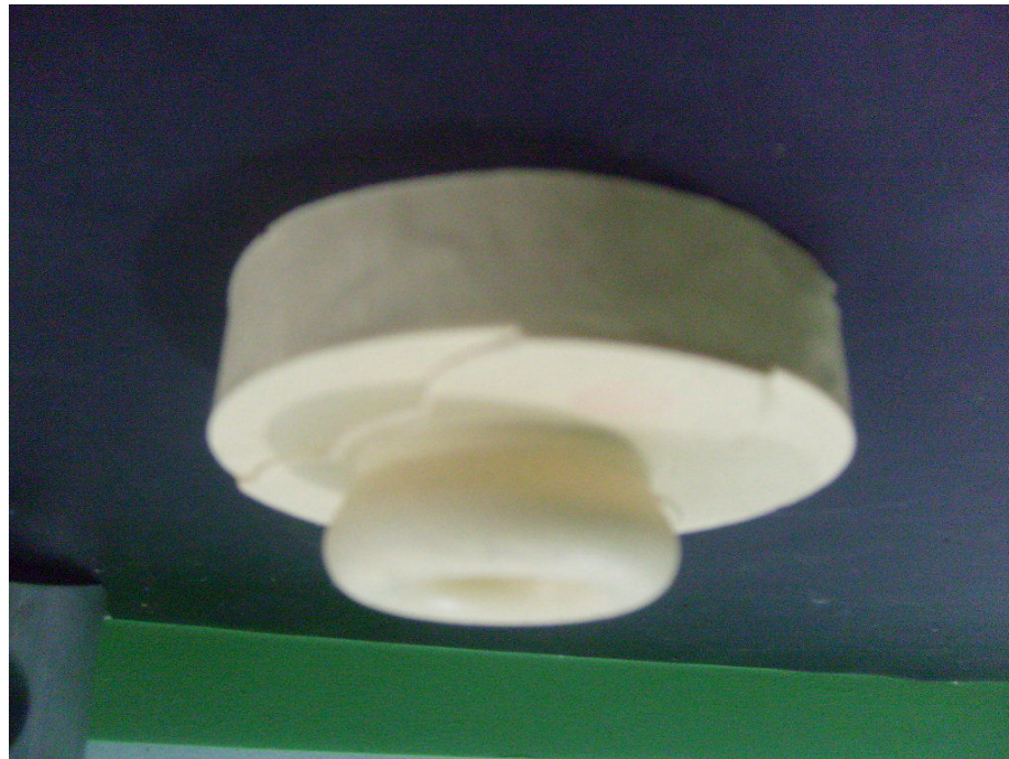
Figura 2. Molde de silicone retirado da cabeça do pistão.
