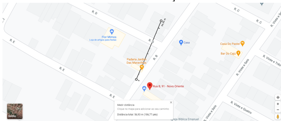
Figura 29 – Alcance de comunicação LoRa do protótipo em ambiente com alta densidade de construções civis
