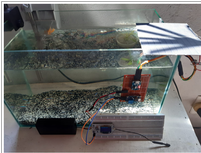
Figura 20 – Sistema de alimentação solar
