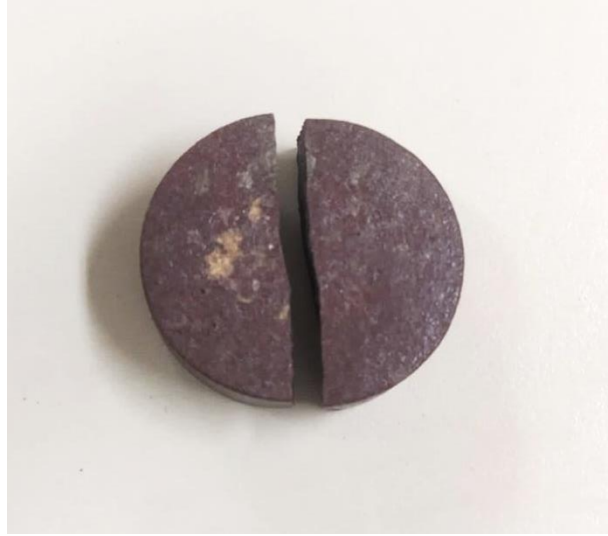
Figura 21 - Amostra fraturada após ensaio de compressão diametral.
