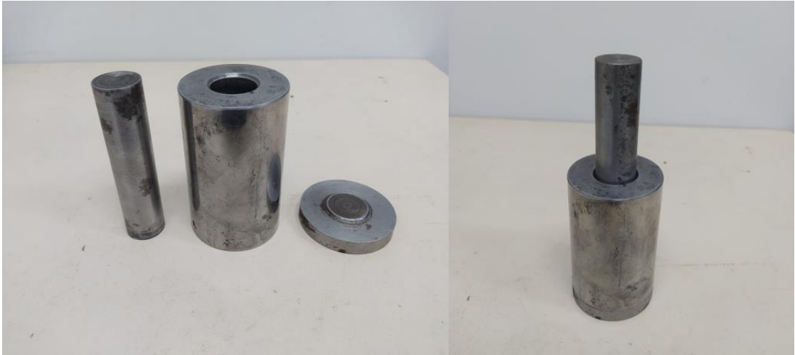
Figura 8 - Matriz metálica para compactação das peças cerâmicas.
