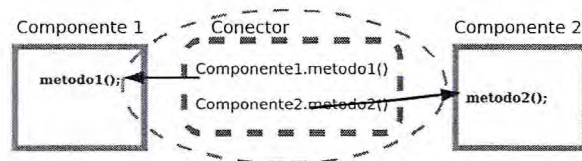
Figura 4.7: Componentes conectados por um conector exógeno.
