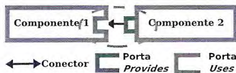
Figura 4.3: Ilustração de um conector endógeno.
