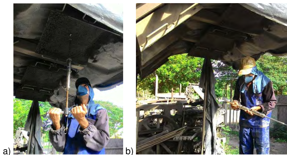
Figura 11 – Utilização da agulha de Proctor: a) aplicação da força necessária para penetração da ponteira. b) realização da leitura.
