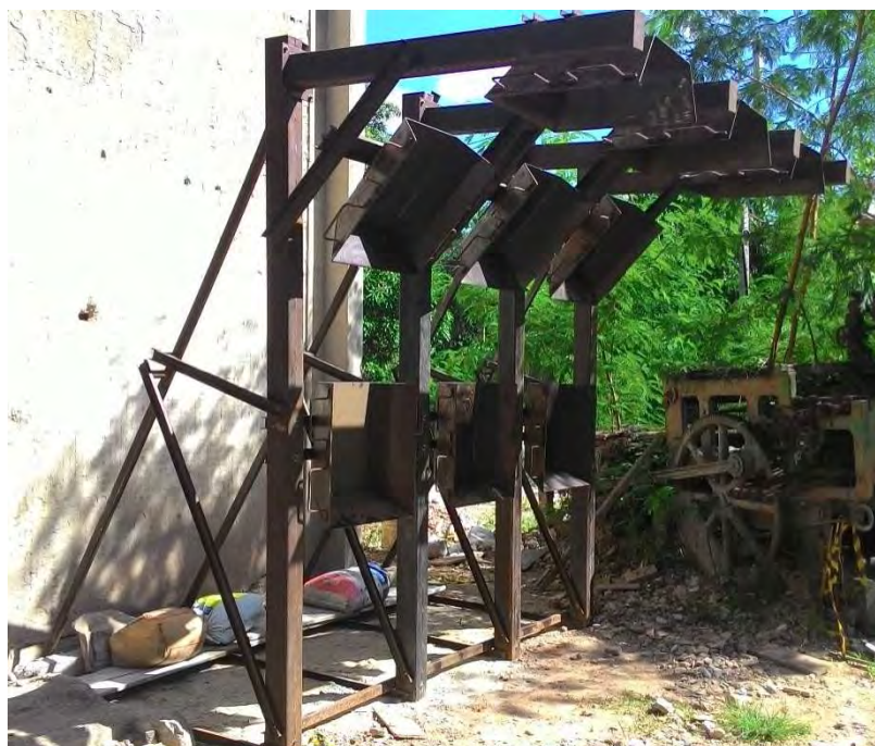
Figura 8 - Estrutura metálica utilizada para posicionamento das formas.
