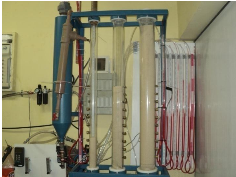
Figura 50 – Foto do aparato experimental, com areia preenchendo até a cota crítica.
