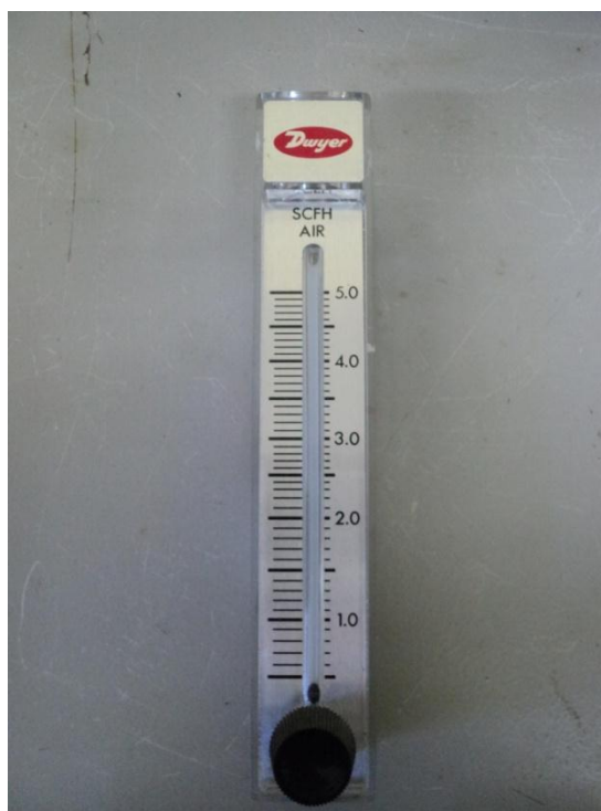
Figura 55 – Medidor de vazão tipo rotâmetro faixa de medição: 0,5 a 5 SCFH.
