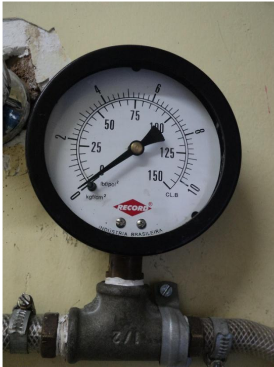
Figura 62 – Manômetro analógico (0-10 kgf/cm 2 ) Fabricante: Record.
