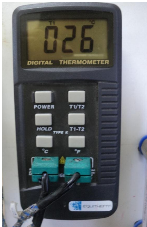
Figura 56 – Termômetro digital portátil com escala de temperatura de -50 a +1300 Fabricante: Equitherm, Modelo: DM6802B.
