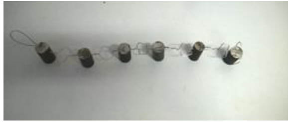
Figura 49. Amostra com suporte para os tratamentos térmicos.
