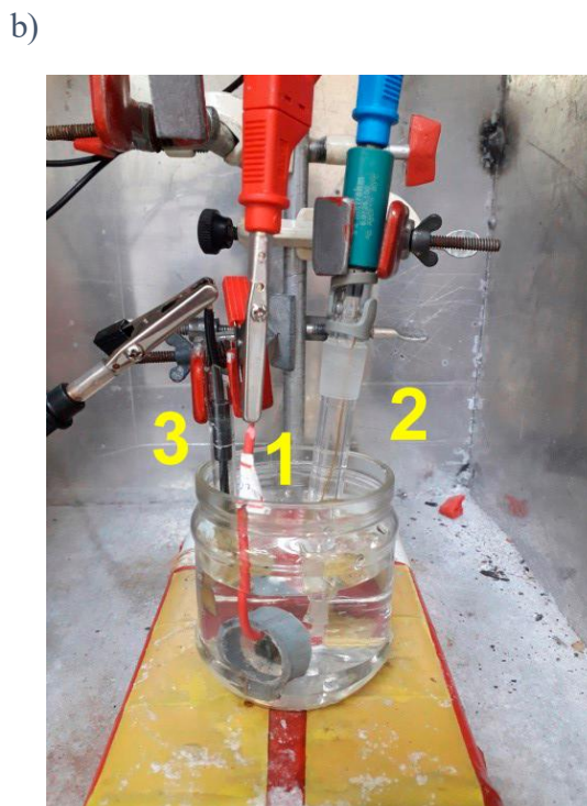
Figura 6 - Montagem da Célula Eletroquímica - a) Imagem teórica b) 1. Contra eletrodo de platina, 2. Eletrodo de referência prata/cloreto de prata ( \text{Ag(s)} / \text{AgCl(s)} , sat. KCl) e 3. Eletrodo de trabalho (amostras utilizadas para análise).
