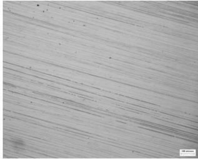
Figura 24 -- Superfície do aço AL-6XNPLUS™ NaCl. tratado a 700°C por 72 horas após ensaio de polarização potenciodinâmica em 0,5 M H 2 SO 4 + 0,5 M NaCl.
