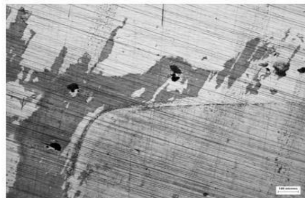
Figura 23 - Superfície do Aço 317L tratado a 700 °C por 72 horas pós ensaio de polarização potenciodinâmica em 0,5 M H_2SO_4 + 0,5 M NaCl.
