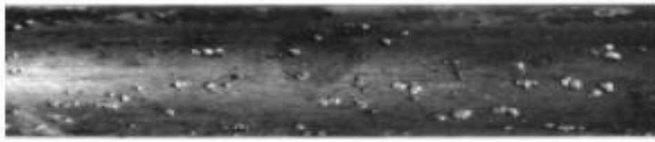
Figura 6 - Corrosão por pites em um aço Inoxidável AISI 304.
