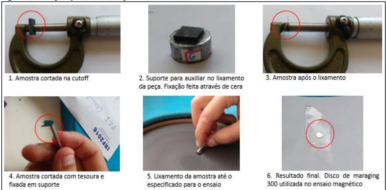
Figura 14 - Preparação da amostra para o ensaio VSM
