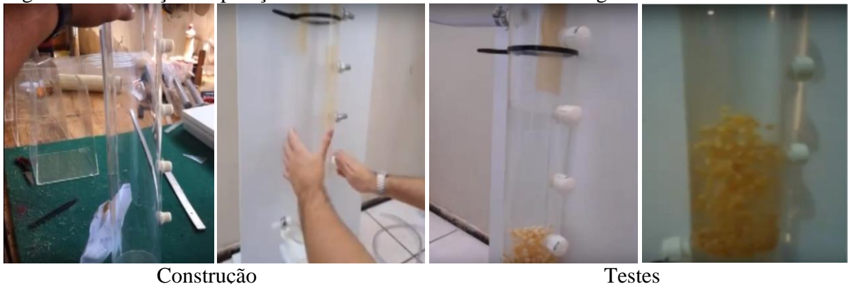
Figura 2. Construção e operação de um leito fluidizado utilizando água e milho.
