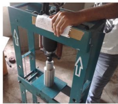
5- posicionar o material na prensa
