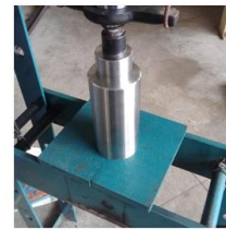
7- deixar descansando 5min com a pressão aplicada
