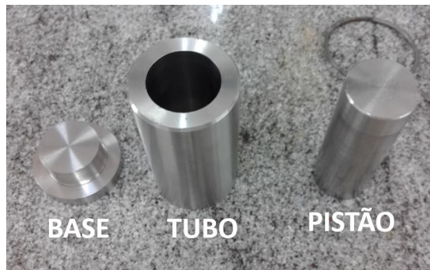
Figura 4 – Molde cilíndrico fabricado em inox
