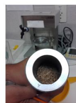
3- preencher com 5 a 30g de material (depende do teste)
