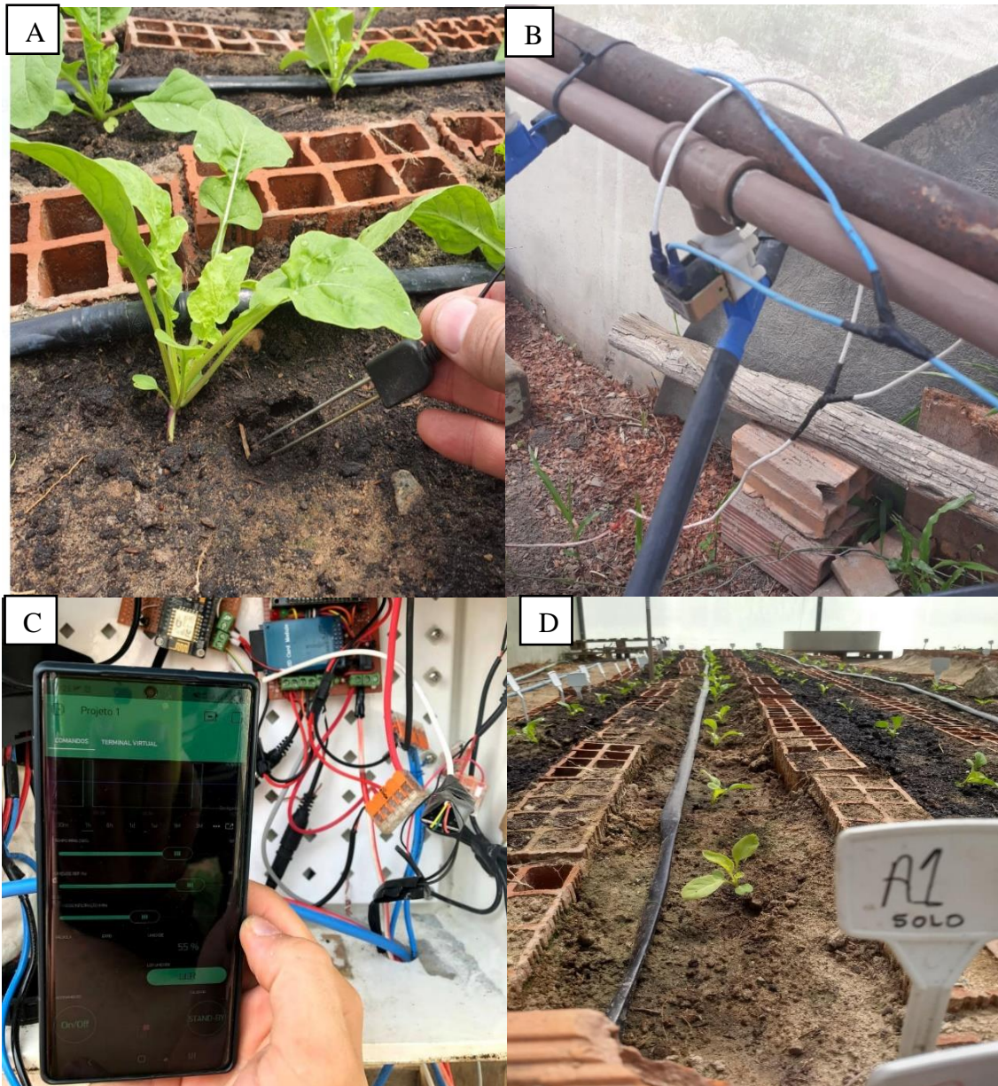
Figura 7 - Sensor de umidade utilizado e armazenamento de dados (A), válvula solenóide instalada (B), aplicativo móvel (C) e fita gotejadora (D)
