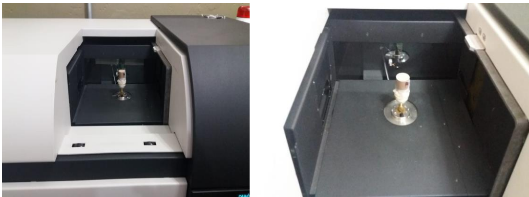
Figura 3- Amostras de solos prontas para serem escaneadas no Microtomógrafo
