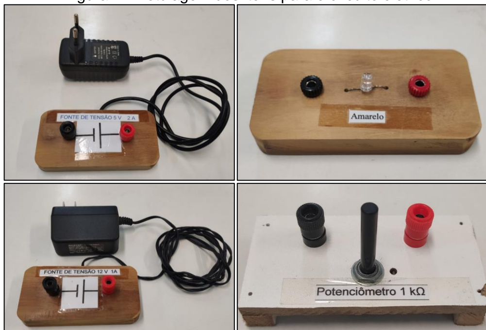
Figura 1 - Rotulagem dos itens para o circuito elétrico
