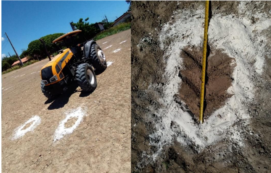
Figura 15 – Determinação da área de contatos dos pneus.
