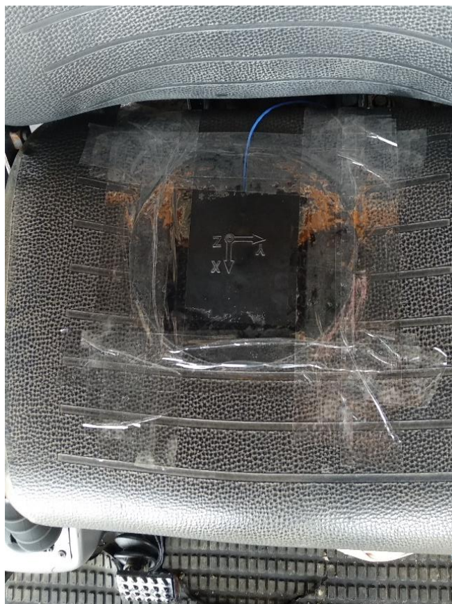
Figura 12 - “Seatpad” fixado ao assento.
