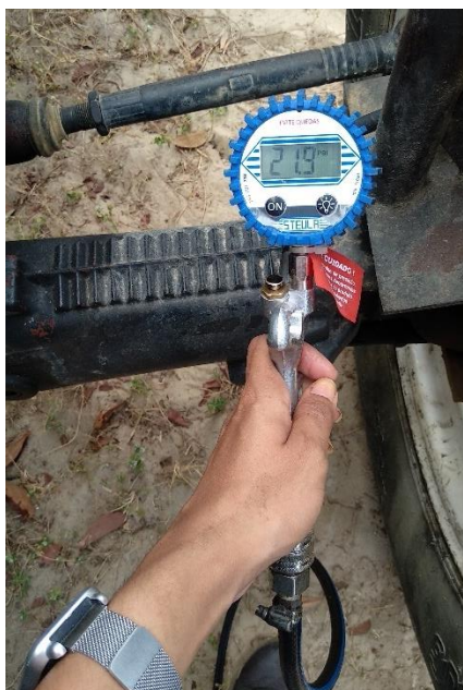
Figura 14 - Aferição da pressão de inflação com calibrador.
