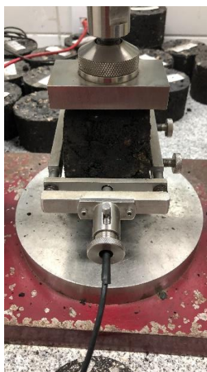
Figura 6 — CP posicionado na prensa para a realização do ensaio de MR, com LVDT
