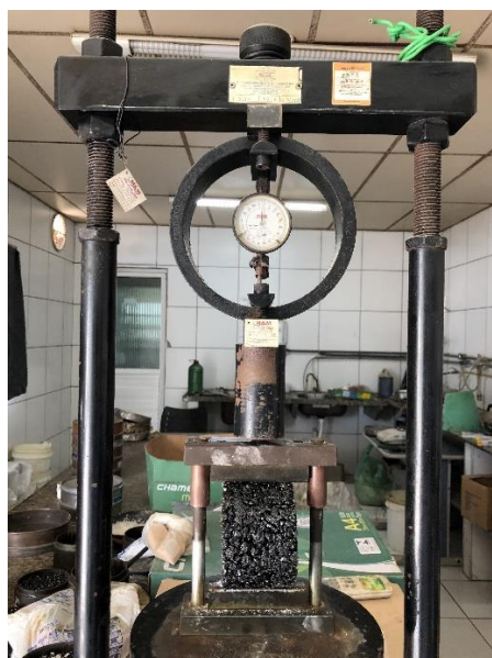
Figura 5 — CP cilíndrico posicionado na prensa utilizada para a realização do ensaio de RT
