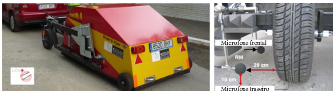
Figura 26 — Trailer CPX e detalhe da posição dos microfones próximo ao pneu de referência
