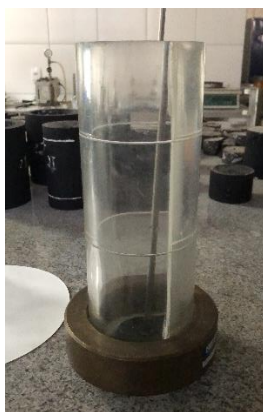
Figura 51 — Drenômetro utilizado na presente pesquisa
