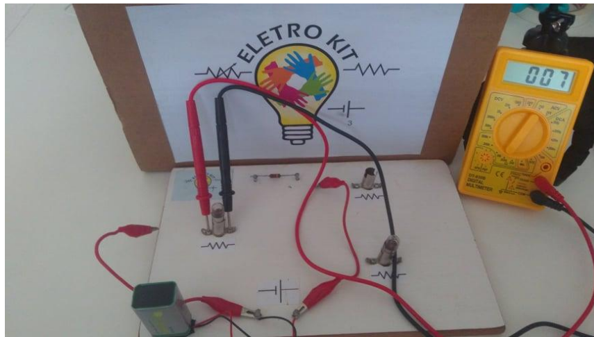
Figura 23 - Medindo a resistência da lâmpada após ser desligada.
