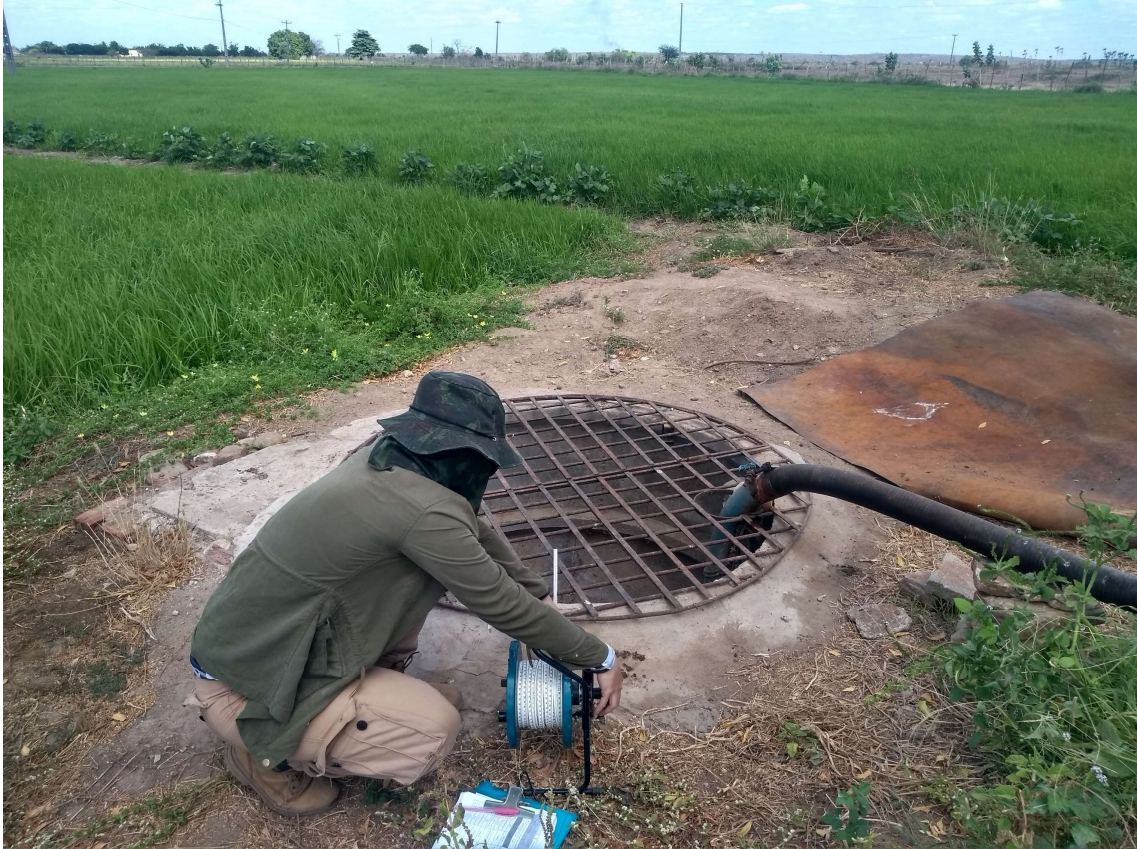
Figura 2 – Medição de nível estático da água em poço do Projeto de Irrigação Morada Nova (PIMN)
