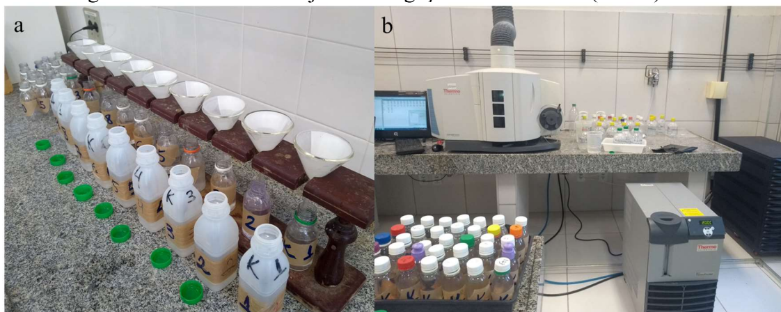
Figura 8 – Preparo – a e determinação – b da concentração de metais pesados e elementos tóxicos das águas subterrâneas do Projeto de Irrigação Morada Nova (PIMN)
