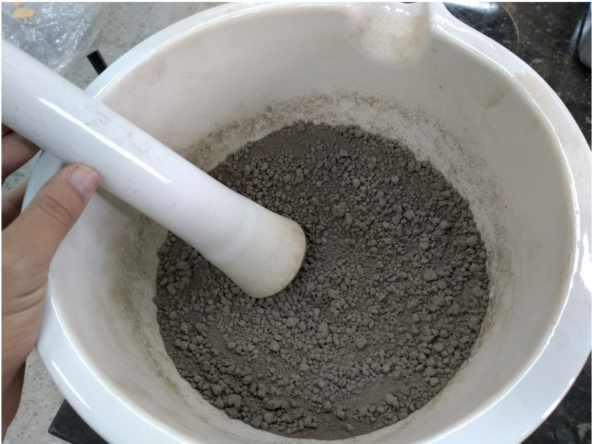
Figura 17 – Destorroamento das argilas
