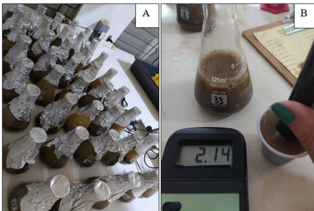
Figura 9 – Preparo do extrato solo:água (A) e determinação da condutividade elétrica do solo (B)
