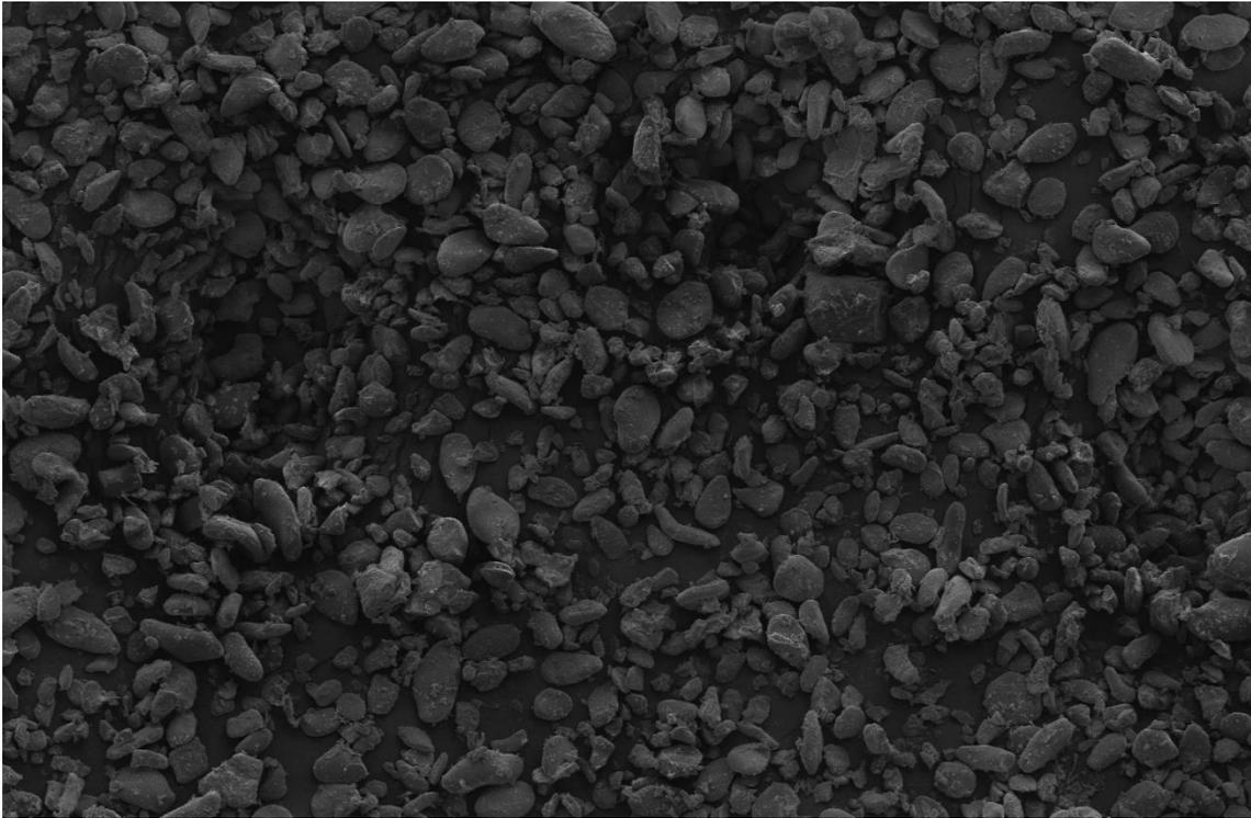
Figura 12. MEV na magnitude 500x para amido de banana com tratamento plasma DBD na frequência de 400 Hz
