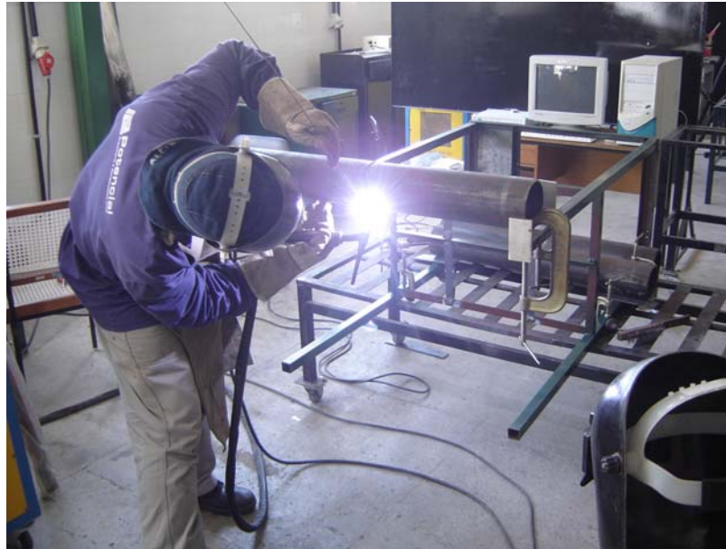
Figura 29. Soldagem manual dos tubos.
