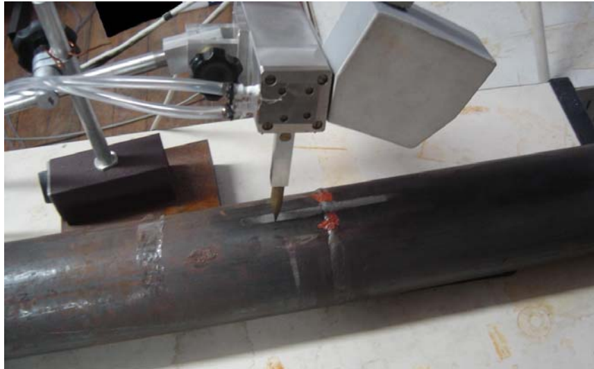
Figura 35. Posicionamento do conjunto tubo/detector sobre a tubulação.
