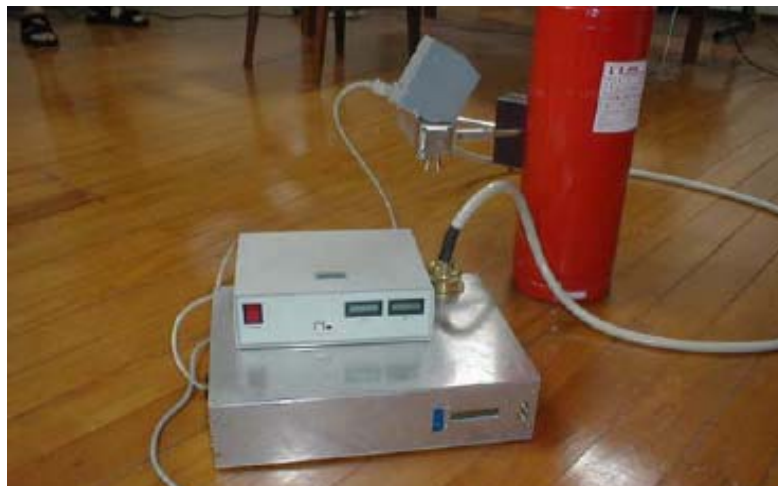
Figura 34. Minidifratômetro para medição de tensões residuais em campo (Assis et al. , 2003).
