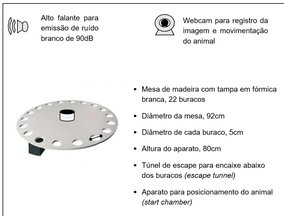
Figura 8 - Descrição do aparato utilizado para o labirinto de Barnes
