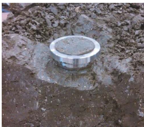
Fig. 5 – Moldagem do corpo de prova para ensaio de compressão edométrico a partir de amostra indeformada (Chagas, 2014).
