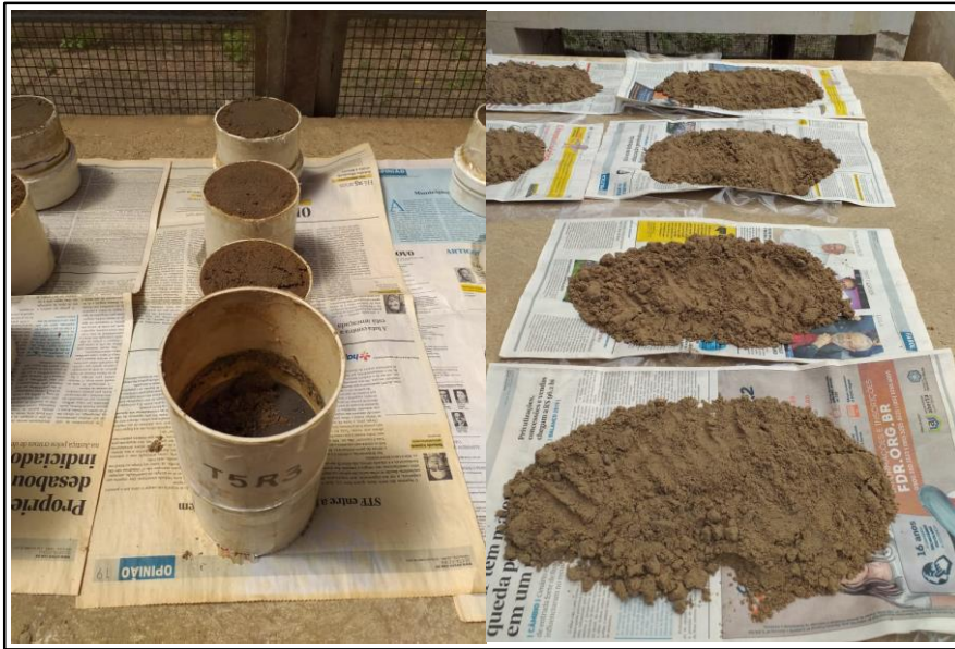
Figura 04 – Desmontagem das colunas de solo.
