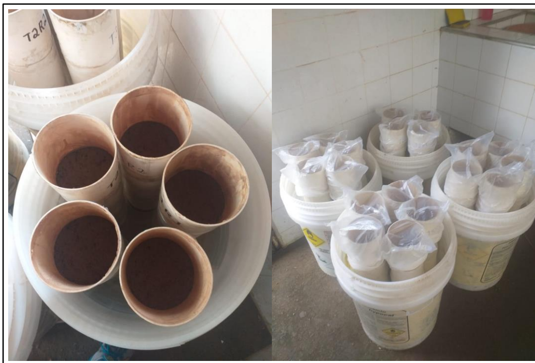
Figura 03 – Colunas de solo imersas em água.
