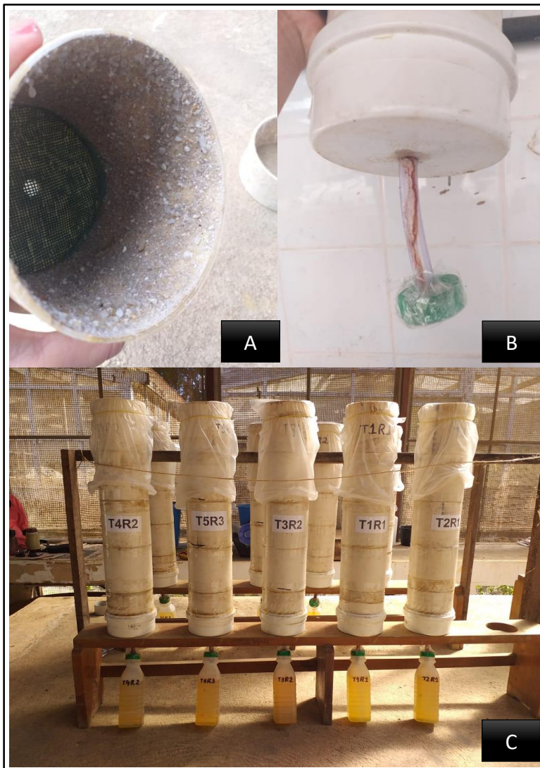
Figura 02 – Montagem das colunas de solo.
