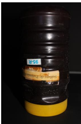
Figura 14. Recipiente de armazenamento do resíduo realizado de forma incorreta( em recipiente de achocolatado).
