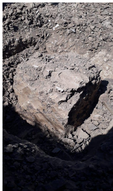
Figura 20 – Moldagem do Bloco com dimensões de 30x30x30 cm.
