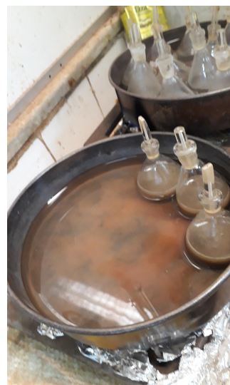
Figura 46 – Picnômetro sendo fervido por 15 min para expulsão do ar
