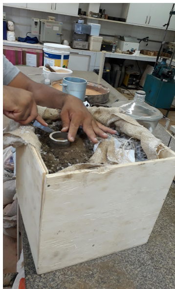
Figura 50 – Cravamento do anel na amostra e moldagem da mesma
