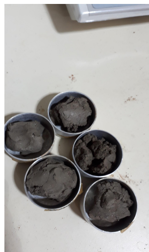
Figura 33 – Amostra para obtenção da umidade
