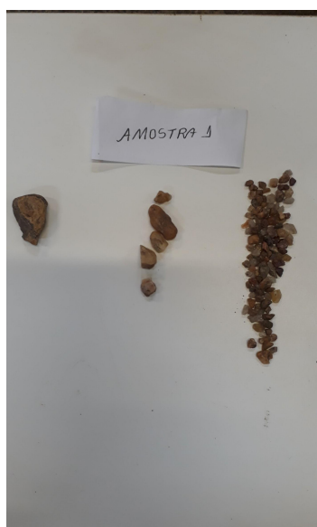
Figura 34 – Peneiramento grosso amostra 1
