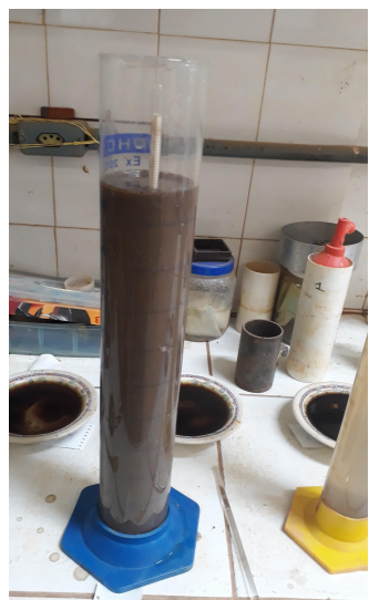
Figura 40 – Colocação do densímetro e realização da leitura
