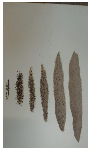
Figura 43 – Peneiramento fino amostra 3
