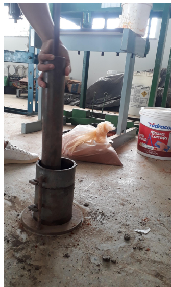
Figura 31 – Processo de compactação das camadas no cilindro
