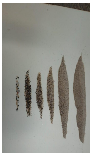
Figura 44 – Peneiramento fino amostra 4
