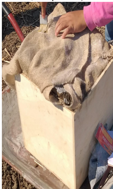
Figura 23 – Acondicionamento da amostra, com preservação da umidade por meio de uso de parafina
