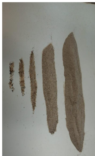
Figura 42 – Peneiramento fino amostra 2
