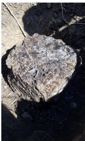
Figura 21 – Aplicação da primeira camada de parafina
