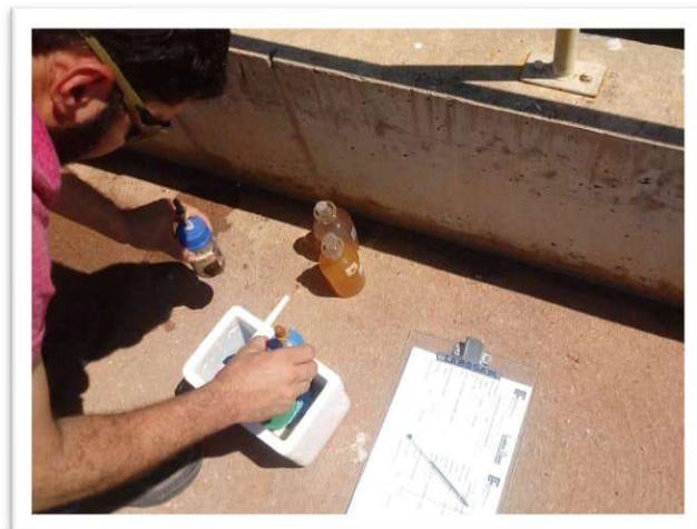
Figura 20: Aplicação dos reagentes, do parâmetro OD.
