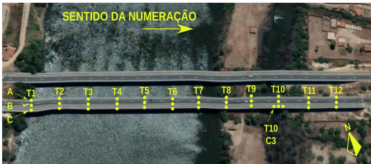
Figura 13 - Padrão de identificação dos pilares
