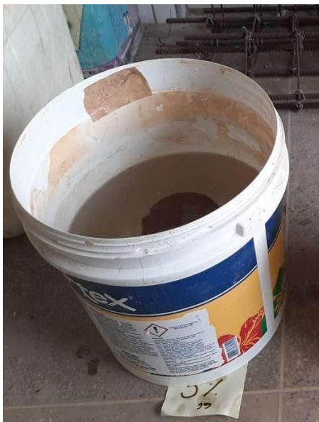
Figura 32 - Corpos de prova em imersão para o ensaio.
