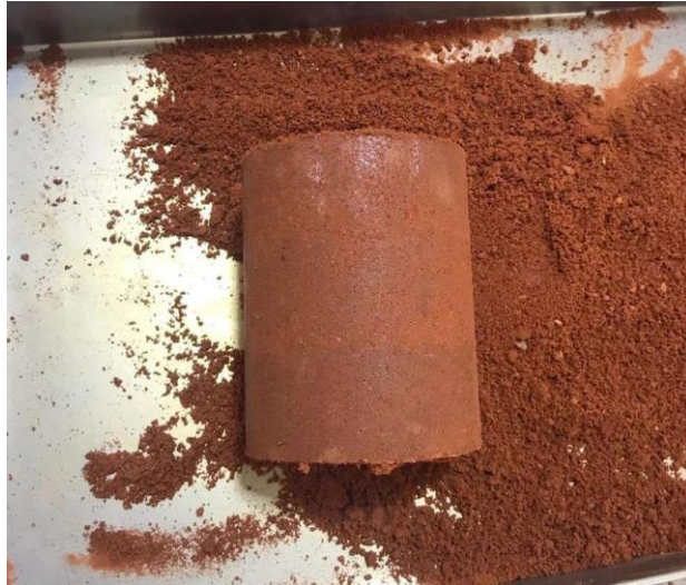
Figura 30 - Corpo de prova do ensaio de Compactação Proctor normal.
