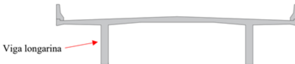
Figura 40: Seção transversal do modelo de ponte trabalhado
