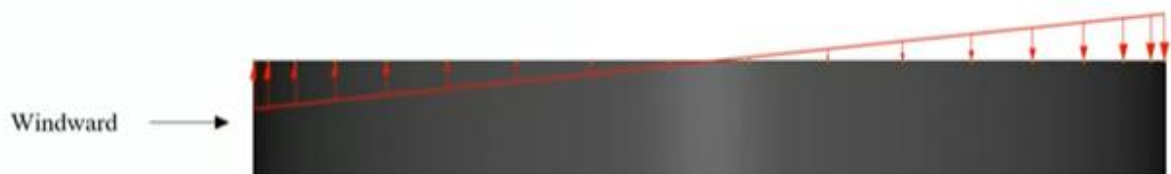
Figura 17 - Conjugados de forças verticais equivalentes à ação do momento no anel adaptador metálico.
