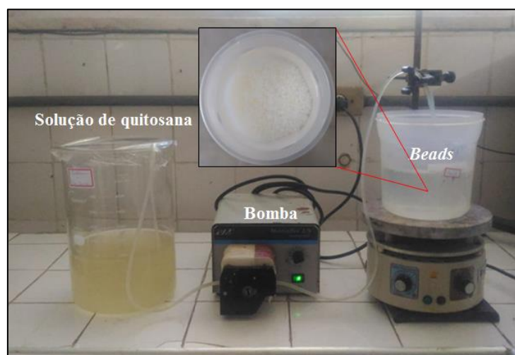
Figura 1: Sistema de gotejamento para produção dos beads .
