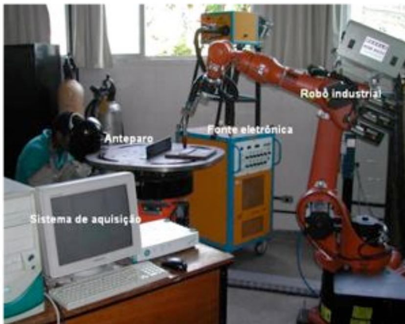
Figura 23. Equipamento utilizado para realização de soldagem automática.
