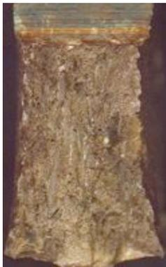
Figura 61. Aspecto da fratura dos corpos de prova Charpy-V da Liga E3 (100 °C). Energia Absorvida média de 39 J.
