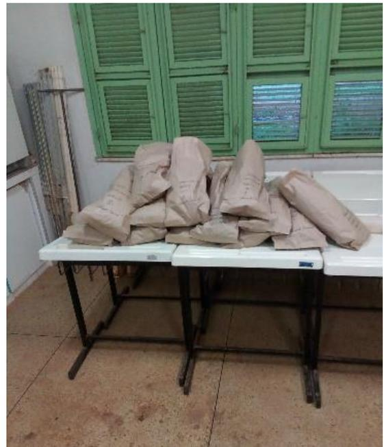
**Fotografia 12:** Subamostras devidamente pesadas, prontas para serem acondicionadas em estufa de ventilação forçada para estimativa da matéria pré-seca.
