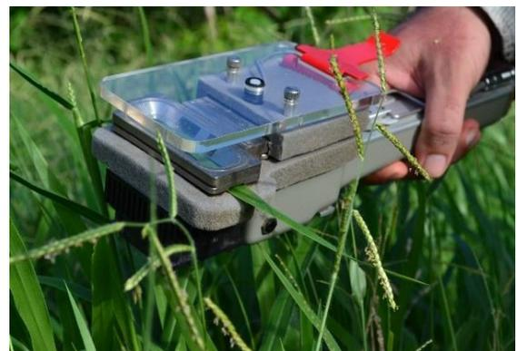
**Fotografia 08:** Avaliação de trocas gasosas utilizando analisador de gás por radiação infravermelha (IRGA, modelo LC-Pro-SD, marca ADC Bioscientific Ltda. Hoddesdon, Hertfordshire, UK).
