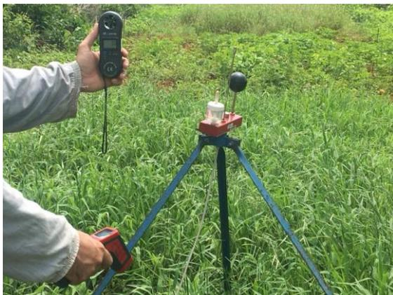
**Fotografia 19:** Avaliação ambiental utilizando medidor de stress térmico, modelo TGD 400 da Instrutherm na posição sol.
