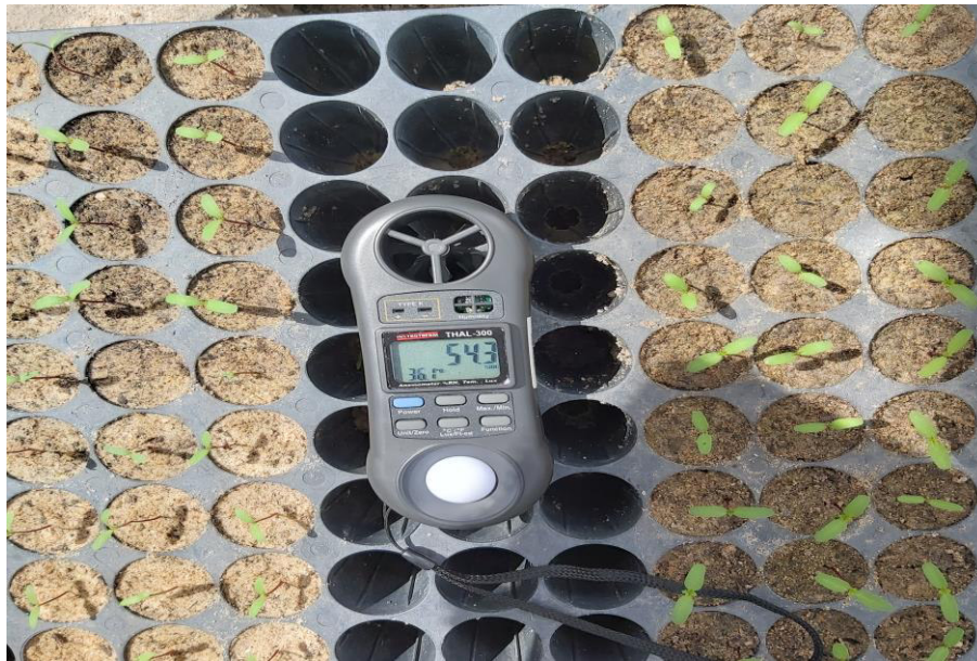
Figura 17 - Termohigrômetro posicionado para avaliação da temperatura no ambiente 2.
