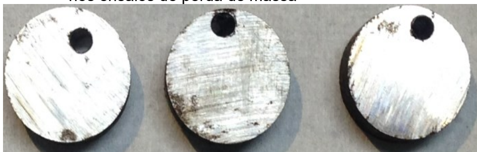
Figura 40 - Foto dos corpos de provas usados nos ensaios de perda de massa
