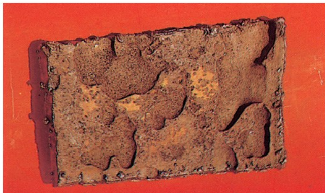
Figura 2 – Corrosão em placas
