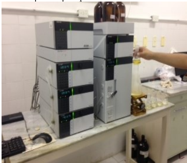
Figura 44 – Fotografia do equipamento de Clae utilizado para separação dos extratos
