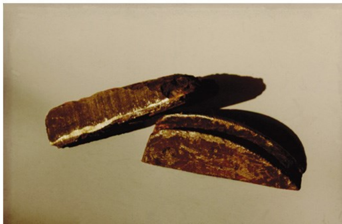
Figura 9 – Corrosão gráfitica do ferro fundido, notando-se o aspecto escuro da área corroída
