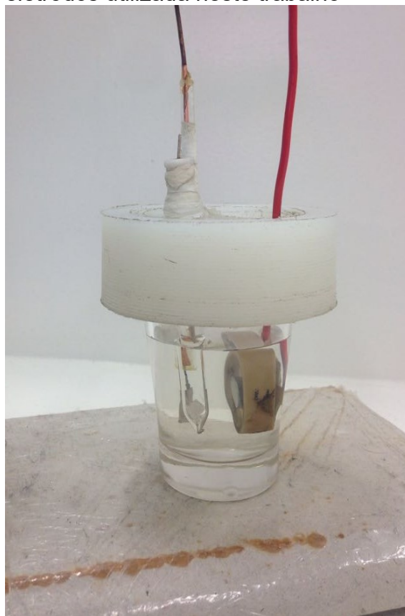
Figura 42 – Célula convencional de três eletrodos utilizada neste trabalho
