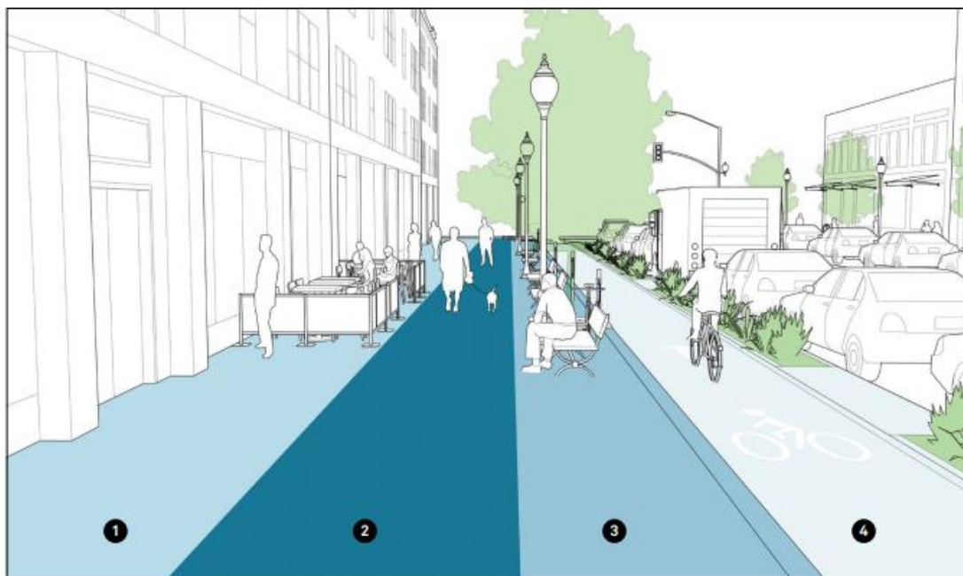
Figura 6 - Calçada ideal dividida em 4 faixas de uso
